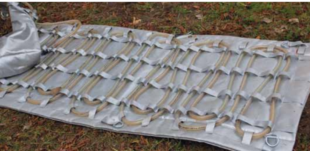
De slangen in de warmtedeken
