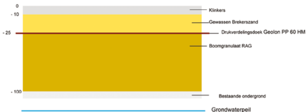
Figuur 1: Dwarsprofiel bodem Houtmarkt Zutphen
