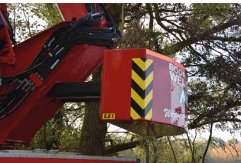
Het uitschuifbare ballastgewicht van 6.600 kilo
