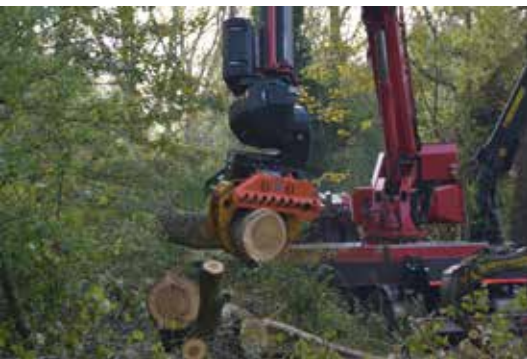
De hydromotoren zijn in een aparte bak geplaatst, net boven de velkop.
