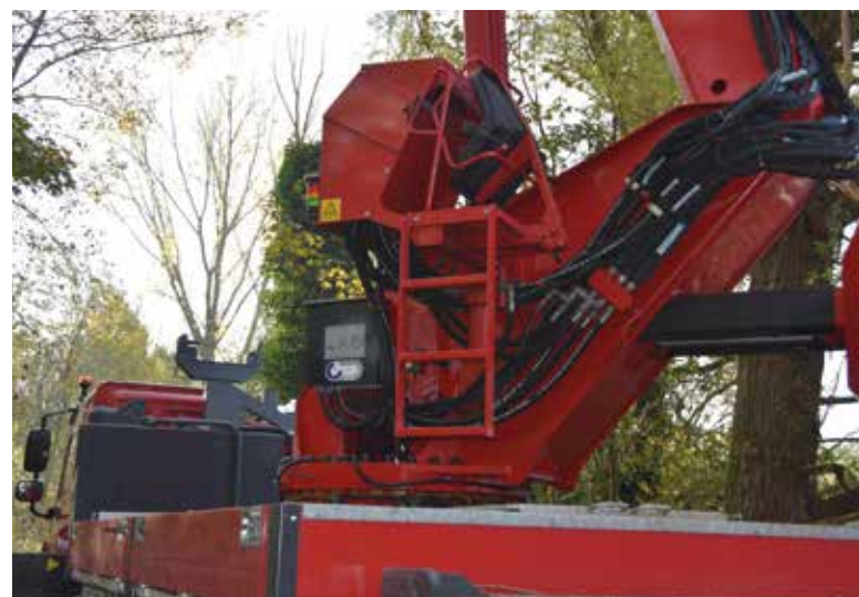
De zware console. De hoofdcilinder zet zich hiertegen af.
