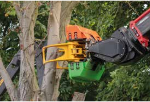
De velkop met twee zaagbakken. De klem weerstaat een momentbelasting van 6.000 Nm.
