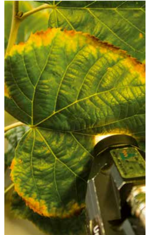
Met een spectrofotometer bepaalden we de fysiologische reflectantie-index, een maat voor de efficiëntie van de fotosynthese.
