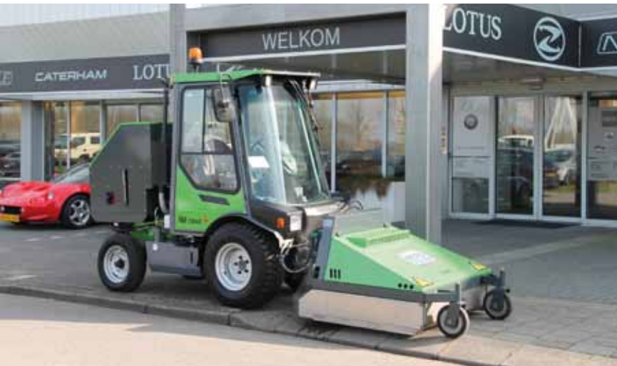
Weedsteam: een combinatie van hete lucht, infraroodstraling en stoom.
